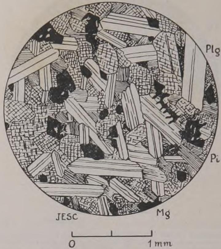
Figura 5 — Cristais ripiformes de labradorita (Plg) e de augita (Pi), muitos dos quais geminados, exibindo textura ofítica tendendo a granular. Observam-se também cristais de magnetita (Mg).
