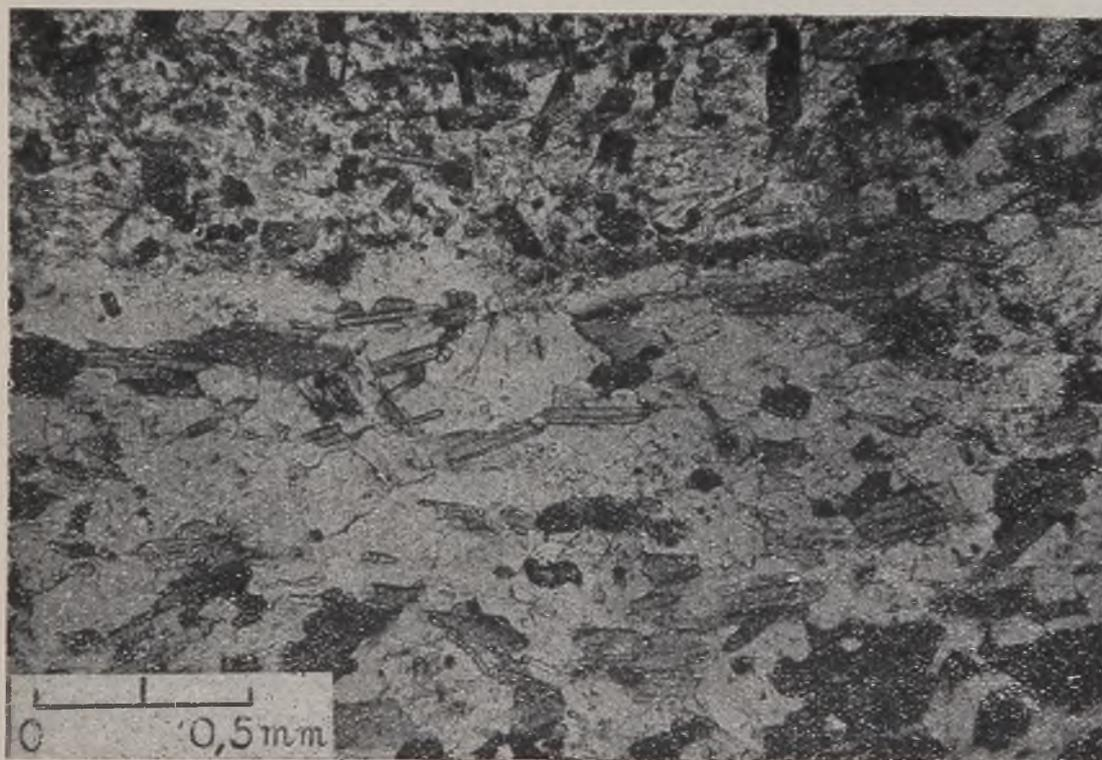
Fotomicrografia 2 — Biotita-hornblenda gnaiss. Na parte superior da fotografia pode ser vista irregular aglomeração de cristaisinhos de biotita, hornblenda, esfeno, apatita e feldspato no interior de um cristal de quartzo que penetrou o gnaiss. Nícois paralelos.
