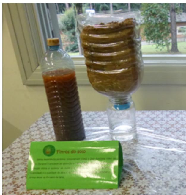
**Figura 9** – O solo filtra e retém impurezas. Observar que a água que sai está límpida.
