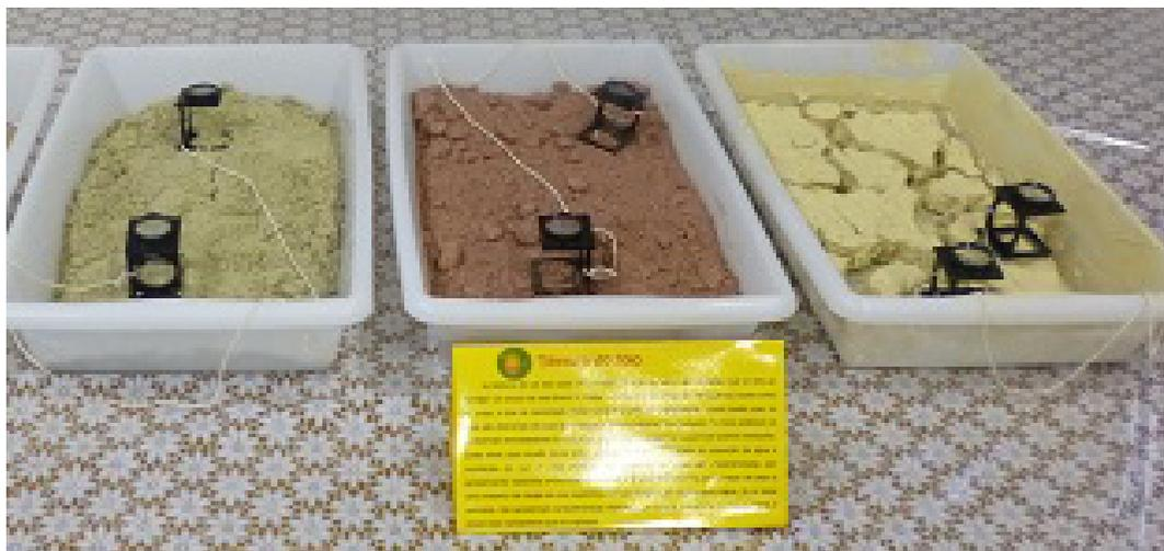
Figura 6 – Da esquerda para direita: areia, silte e argila presentes no solo.
