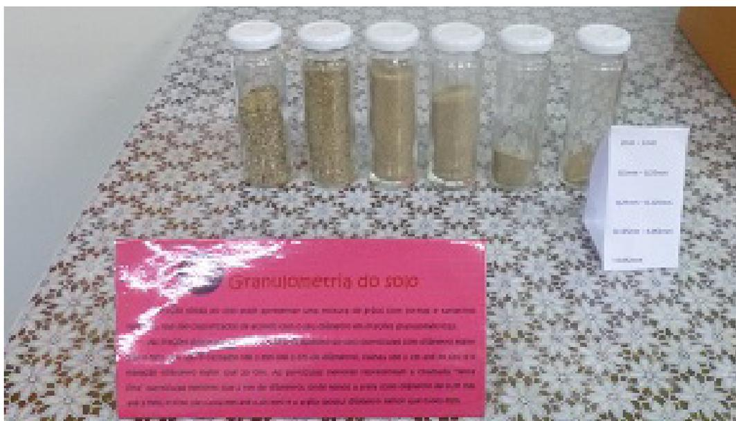
Figura 7 – Frações granulométricas da fração areia do solo.
