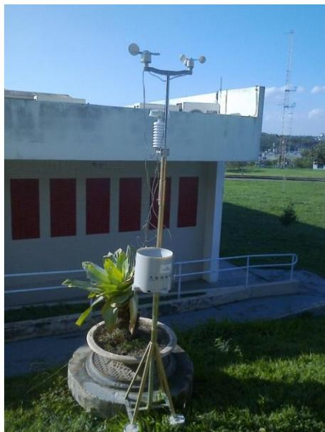
**Figura 1:** Estação meteorológica móvel.
